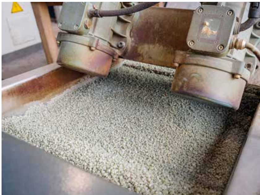
In der InnoRecycling in Eschlikon werden aus Siloballen-Folien Granulat. Daraus werden zum Beispiel zu Rohre hergestellt.
